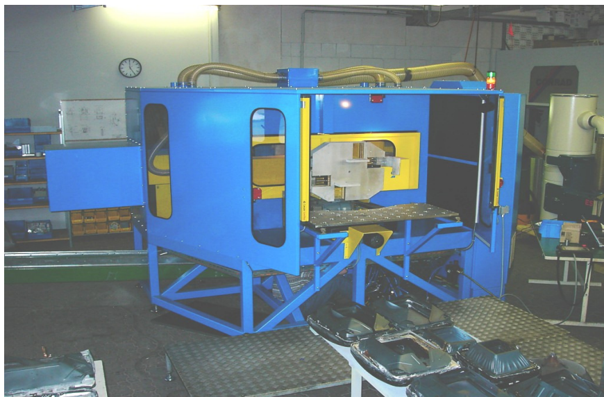
Vollautomatische Trennschleifanlage. 80 Bildschirme / Std.
